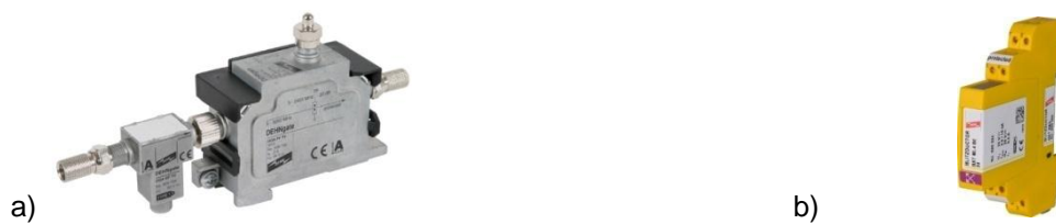
Rys.3 Ograniczniki przepięć do ochrony linii sygnałowych na granicy stref O_A/1 a) Ogranicznik do ochrony systemów TV-SAT – przewód koncentryczny -2,5kA (10/350) b) Ogranicznik uniwersalny do ochrony 4 żył przewodów - całkowity prąd 10 kA (10/350)
