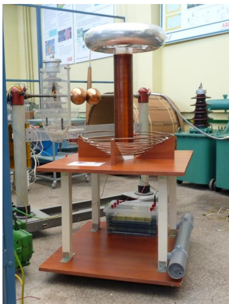
Rys. 8. Wykorzystana konstrukcja Transformatora Tesli.
