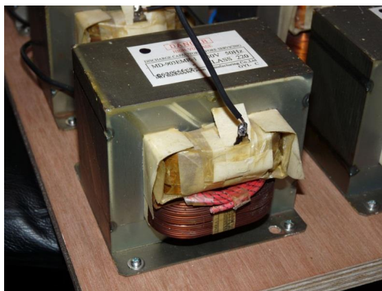
Rys. 2. Jeden z transformatorów wykorzystanych do budowy układu zasilania Cewki Tesli .
